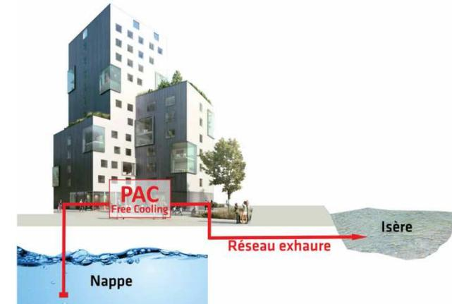
Schéma de principe d'une pompe à chaleur collective
