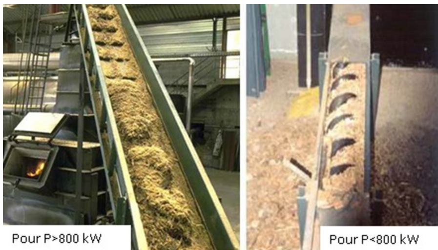
▲ Figure 16 : Système de transfert par convoyeur de reprise (à gauche) et vis d'Archimède (à droite)
